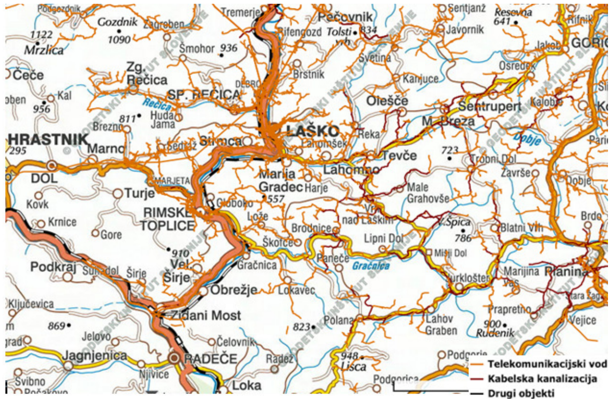
Slika 4: Telekomunikacijska infrastruktura občine Laško
