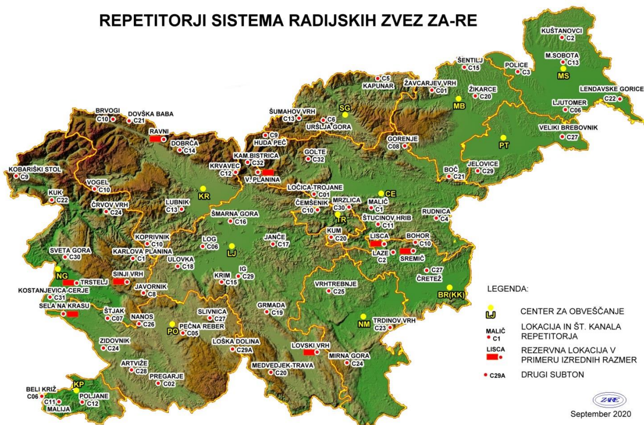
Slika 4: Repetitorske postaje s kanali sistema ZA-RE
